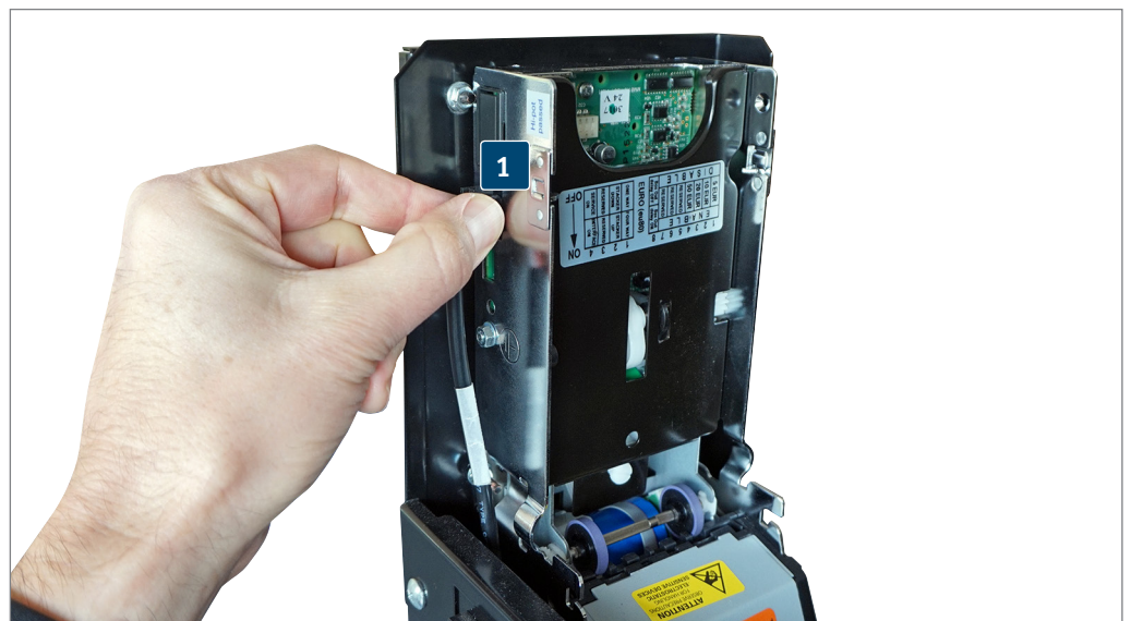
Abb 31: Banknotenlesegerät - MDB-Stecker mit dem Banknotenlesegerät verbinden
